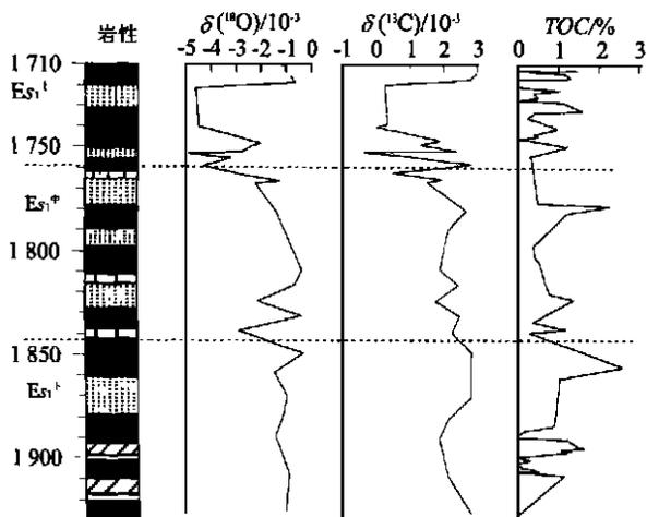
图 3 2-2-18 井沙一段介形虫壳体 ( $^{18}\text{O}$ ) 和 ( $^{13}\text{C}$ ) 及生油岩 TOC 垂向变化曲线
